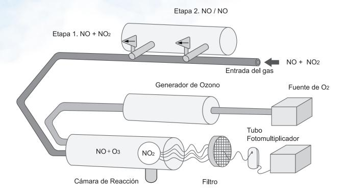
Figura 13. Esquema del principio de operación para un analizador de óxidos de nitrógeno.
