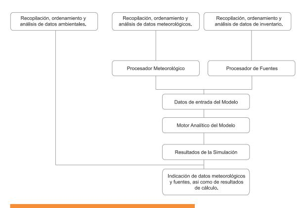
Figura 1. Estructura básica de una simulación.
