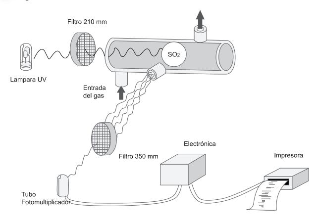
Figura 14. Esquema del principio de operación para un analizador de dióxido de azufre.
