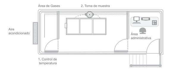
Figura 7. Arreglo de una estación de monitoreo
