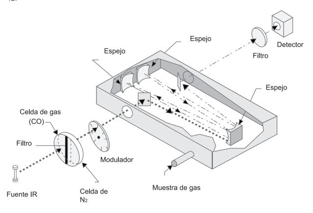
Figura 12. Esquema del principio de operación para un analizador de monóxido de carbono.
