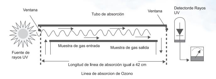
Figura 10. Esquema del principio de operación para un analizador de ozono.
