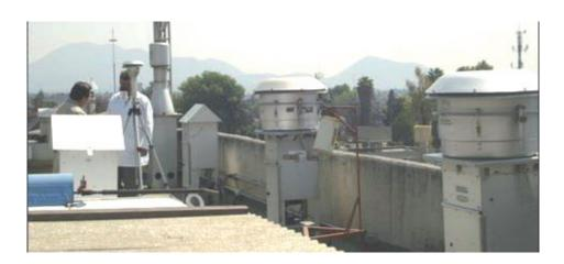
Figura 15. Muestreadores de alto volumen con cabezal.
