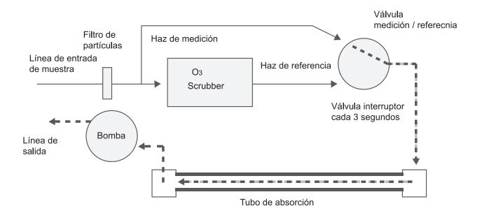
Figura 11. Componentes básicos de un analizador de ozono.
